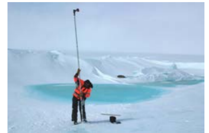
Merijälle asennettiin jään lämpötiloja mittava poiju On sea ice, an automatic buoy was deployed for measurement of sea ice vertical temperature profile. Kuva | Photo: Priit Tisler
