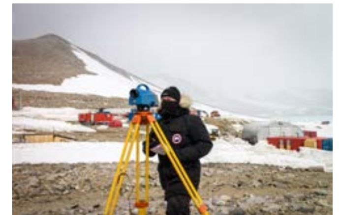
Vaaituksella varmistetaan Troll AA -painovoimapisteen stabiilisuus painovoimamittausten välillä Levelling is used to ensure that the gravity point Troll AA has stayed stable between gravity measurements Kuva | Photo: Jyri Näränen
