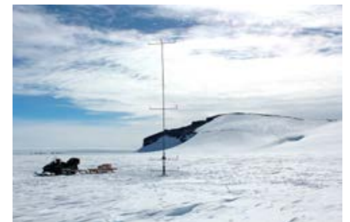
Kahden 10 metriä korkean säämaston avulla mitattiin ilmakehän lämpötilan vertikaalijakaumaa ja tuulen nopeuksia eri korkeuksilla Two ten-metre-high weather masts enabled the measurement of the vertical distribution of air temperature and wind speed. Kuva | Photo: Priit Tisler
