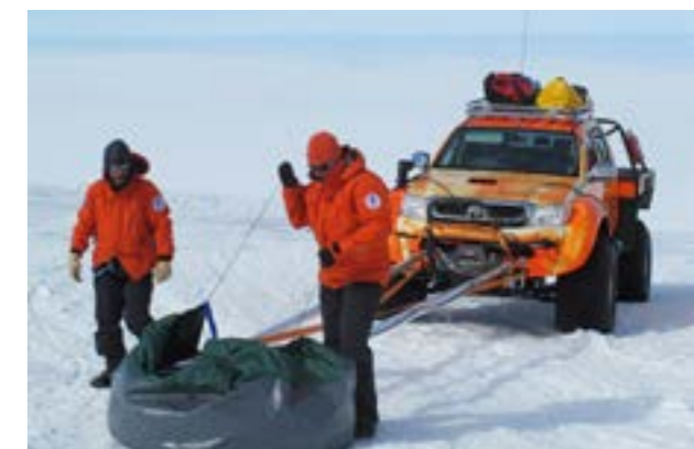
Ennen jätteen kuljetusta uusi yhdysreitti Neumayer-Kohnen huoltoreitille maatuokattiin. Before setting off to transport station waste to Neumayer-Kohnen service route, the new route was ground radar surveyed. Kuva: FINNARP
