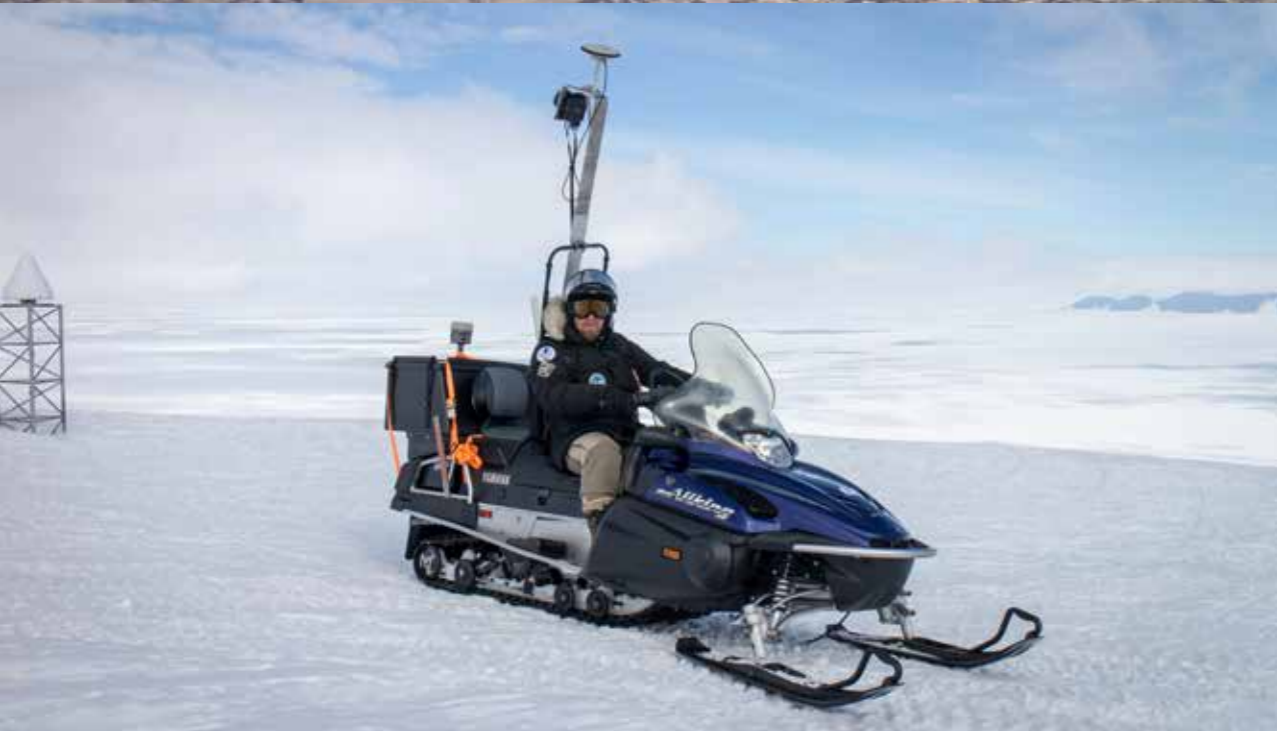
Mobiilia laserkeilausta moottorikelkalla. Mobile laser scanning using a snow mobile.
